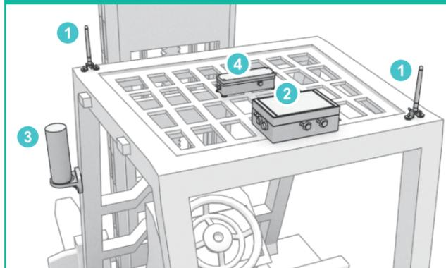
① モノポールアンテナ ② 制御ユニット ③ 信号灯 ④ トリガー送信ボックス(小) ⑤ ICタグ ※接続には各種ケーブルが必要
